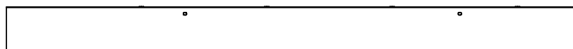
C1 | EXTRÉMITÉ DE SOLIVE - A4M01471 (x2) | 1 3/8 po X 5 1/4 po X 65 3/4 po (36 x 134 x 1670)
